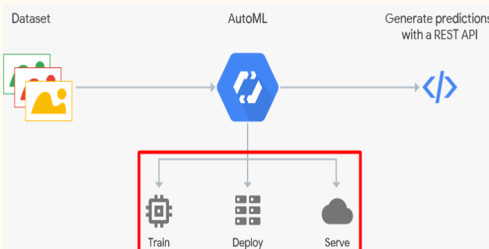
图表 68：AutoML 工作原理（红色部分自动完成）
